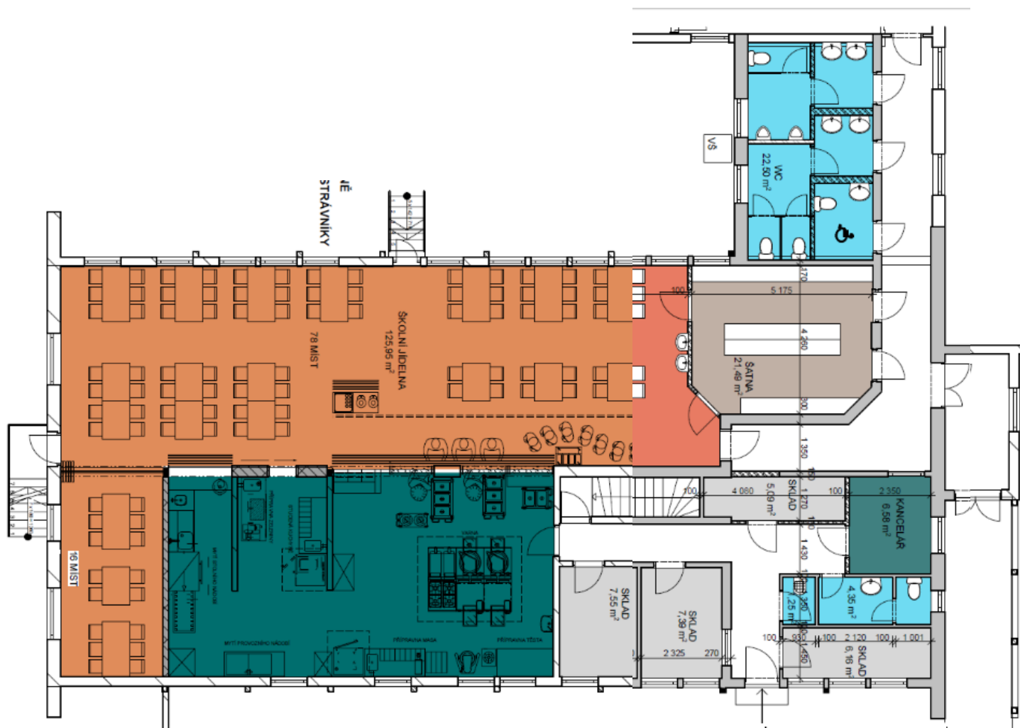
Obr. Nová dispozice školní jídelny – rekonstrukce ŠJ přinesla větší počet míst k sezení, dodržení hygienických norem a vyšší kapacitu školní jídelny
